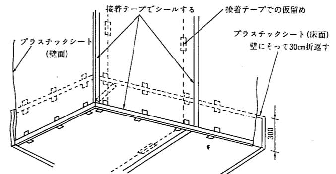
図表3-17 床面の養生例
