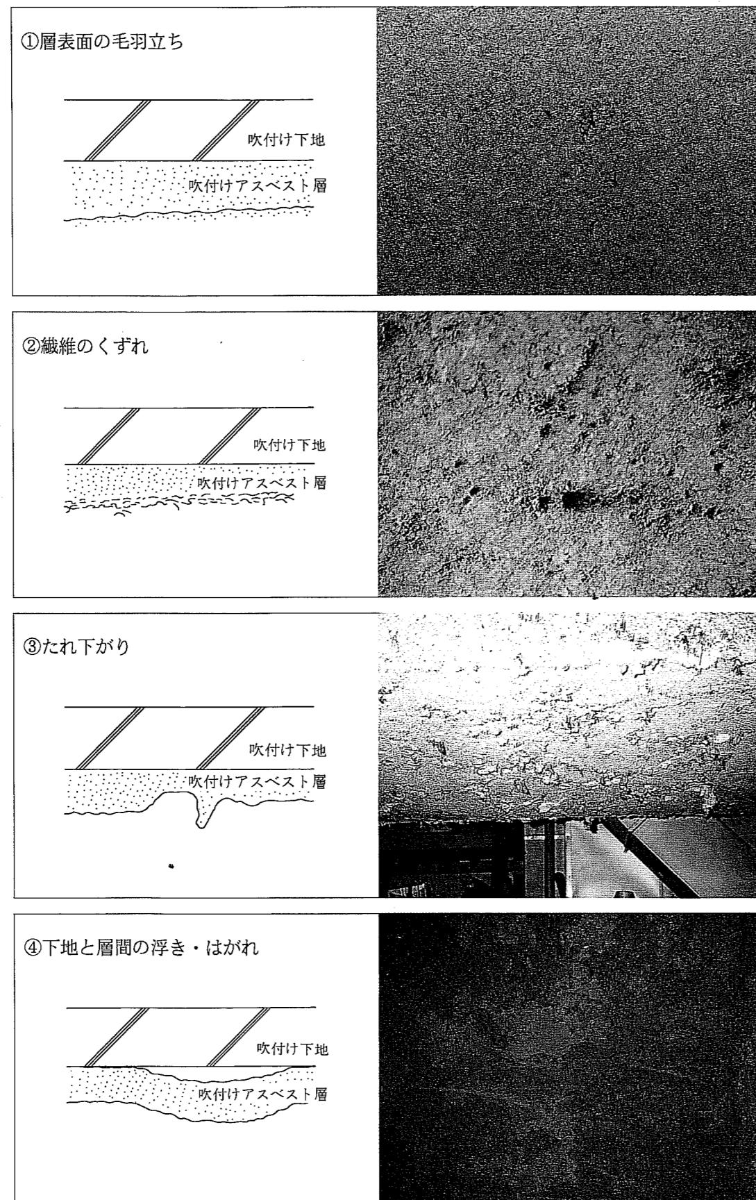
図表3-12 吹付け石綿の劣化損傷状態のモデル図（その1）
