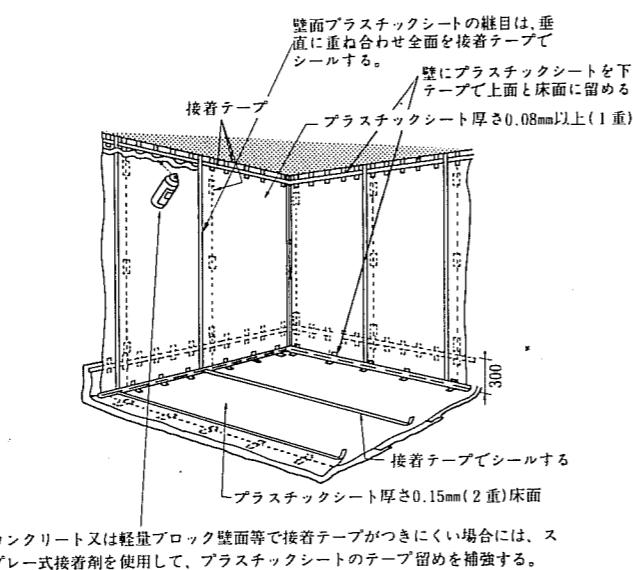
図表3-16 壁面の養生例
