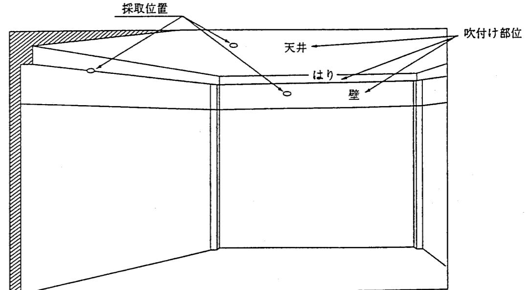
図1 天井、壁における採取位置の例
