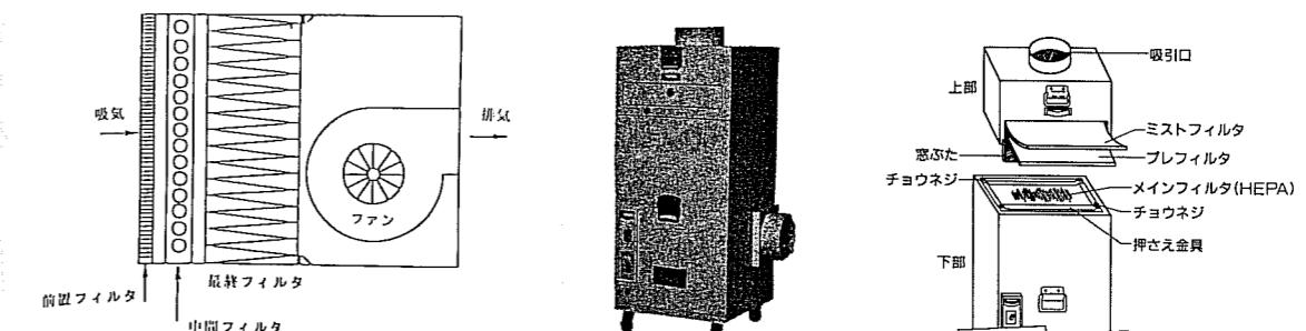
図表 3-19 標準的な集じん・排気装置の構造例
